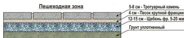
Рисунок 1 – Схема укладки тротуарной плитки
