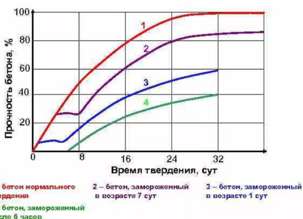
Рисунок 4 - Влияние отверждения на прочность бетона
