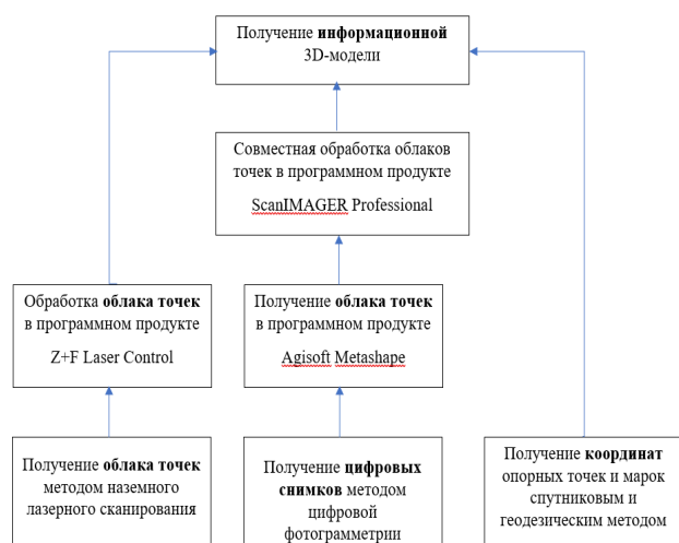
Рисунок 1 – Схема информационных потоков при совместной обработке облаков точек, полученных методами цифровой фотограмметрии и наземного лазерного сканирования
