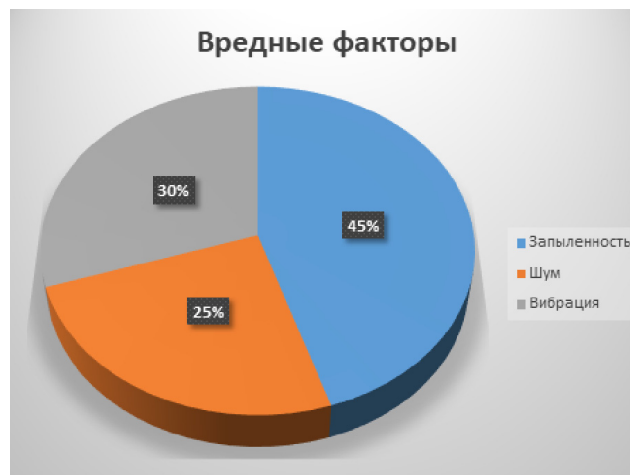
Рисунок 3 – Вредные производственные факторы при уплотнении основания
