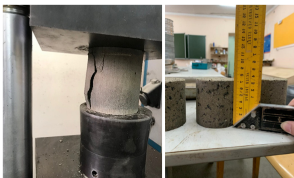
Рис. 1. Определение предела прочности на сжатие в сухом состоянии
