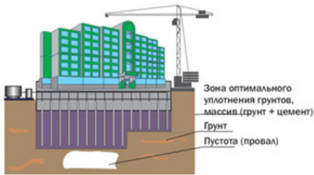
Рис.3 – Установка свайно-плитного фундамента в условиях образования карстового провала
