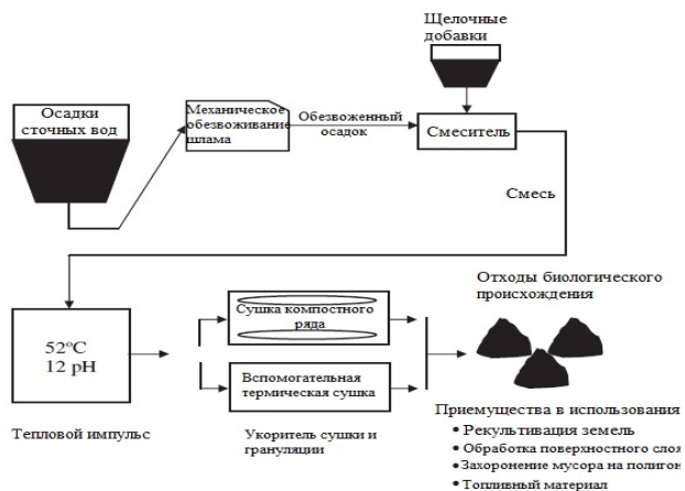
Рис. 1. Технология обработки осадков городских сточных вод путем сжигания
