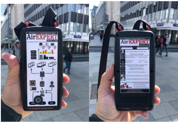
Рисунок 1 - Лицевая и обратная сторона мобильного измерителя концентрации пыли AirExpert Mini PM с серийным номером АЕМ-PM20003, изготовленный ООО «Союзатомприбор»
