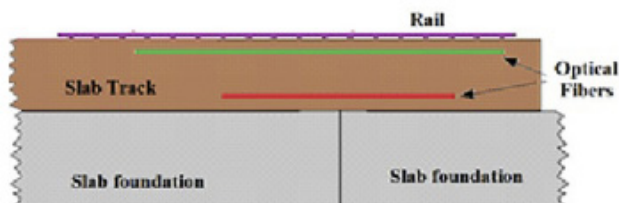
Рисунок 5. Схема заделки волоконно-оптических кабелей в безбалластную путевую структуру (вид сбоку)
