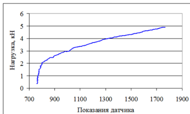
Рисунок 5 – Диаграмма зависимости показаний датчика ширины раскрытия трещины от прилагаемой к образцу нагрузки
