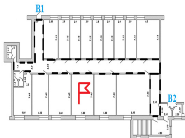
Рис. 3. – План эвакуационных путей 1 этажа жилого корпуса
