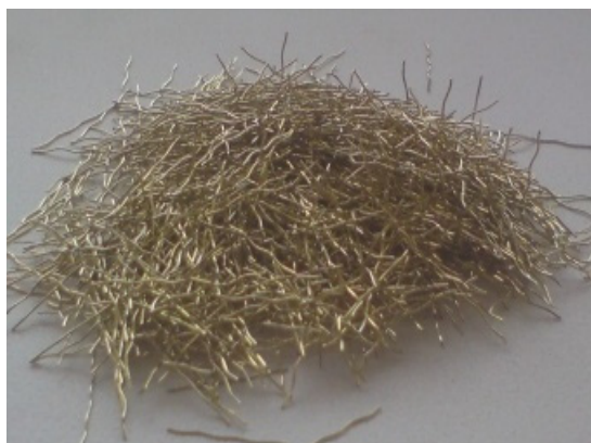
Рисунок 1 – Стальная проволочная фибра
