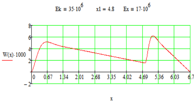
Рисунок 3 – График прогибов при намотке высотой 4,8 м
