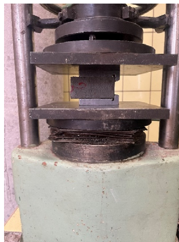
Рис. 4. Испытание балочек на 7 суток.
