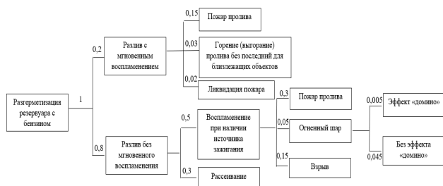
Рисунок 5 – Дерево событий при разгерметизации резервуара с бензином
