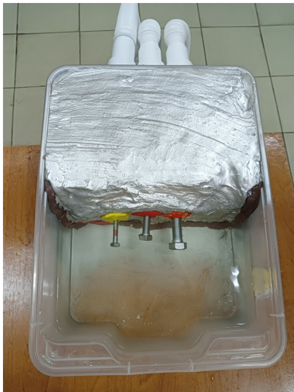
Рисунок 1 – Испытательная емкость с моделью тела дамбы и вставленными болтами-заглушками: а) в желтой пробке – болт-заглушка М8; б) в красной пробке – болт-заглушка М12; в) в красно-желтой пробке – болт-заглушка М16.
