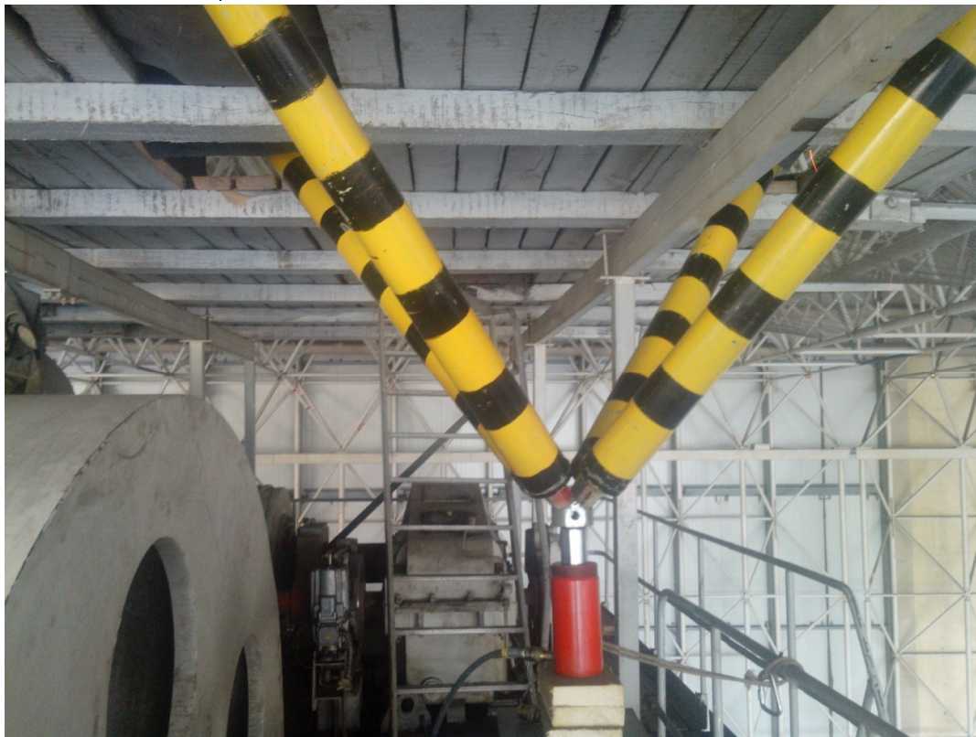
Рисунок 7. Общий вид гидравлического цилиндра и разгрузочной рамки в процессе выполнения процесса разгрузки
