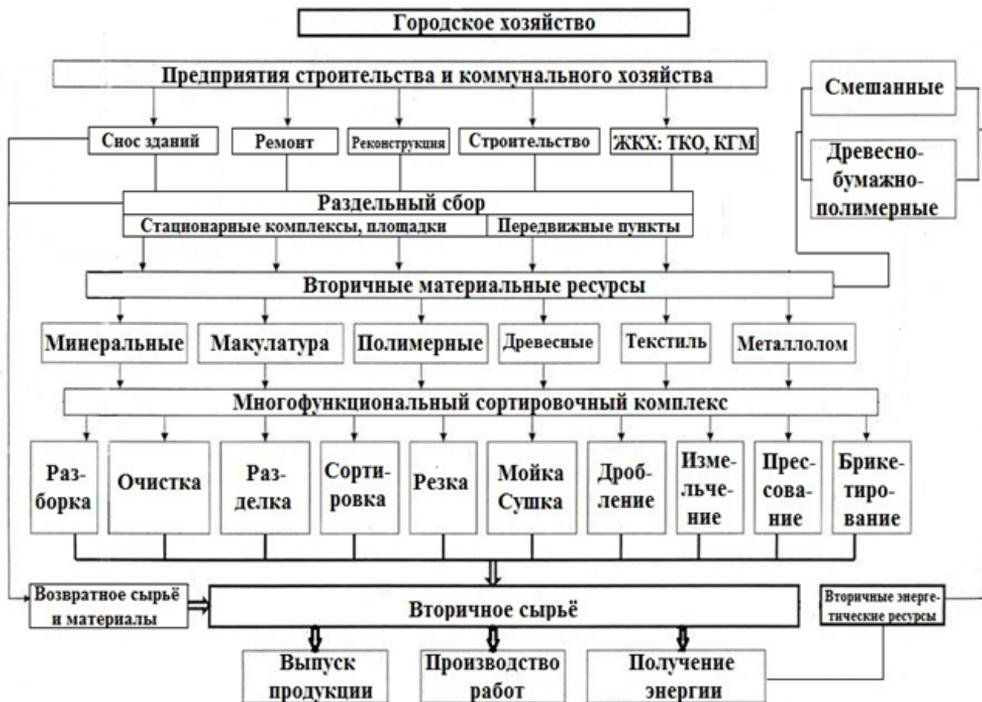
Рис.4. Функционально-техническая схема обращения с ВР
